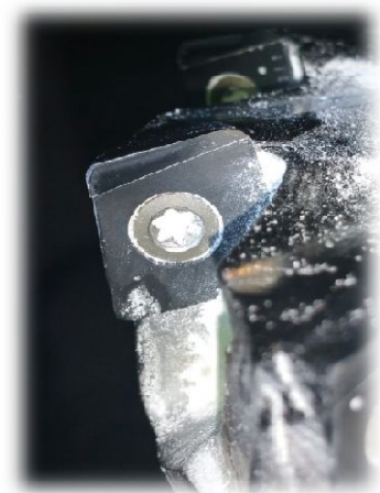
Verschleiß nach 86.400 cm 3 Span Standzeit 22 h (weiter im Einsatz)
